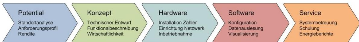
Abbildung 30: Vorgehen zur Einführung des Energiemonitorings [eigene Darstellung]
